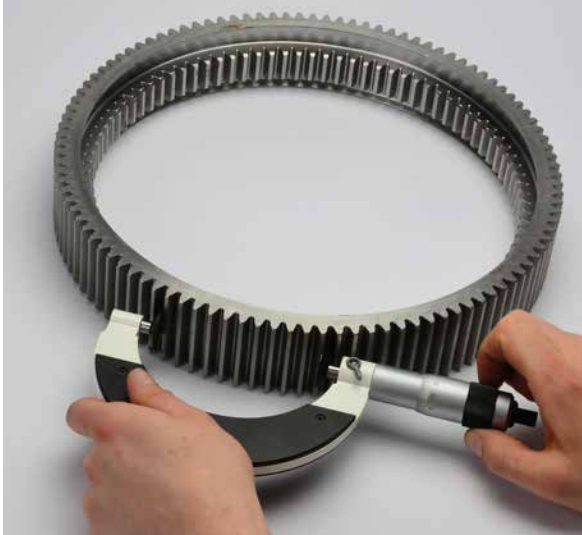
Abb. 1 – Zahnweitenmessung bei Außenverzahnung
