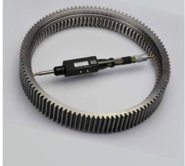
Abb. 2 – Messung des diametralen Zweikugelmaßes bei Innenverzahnung
